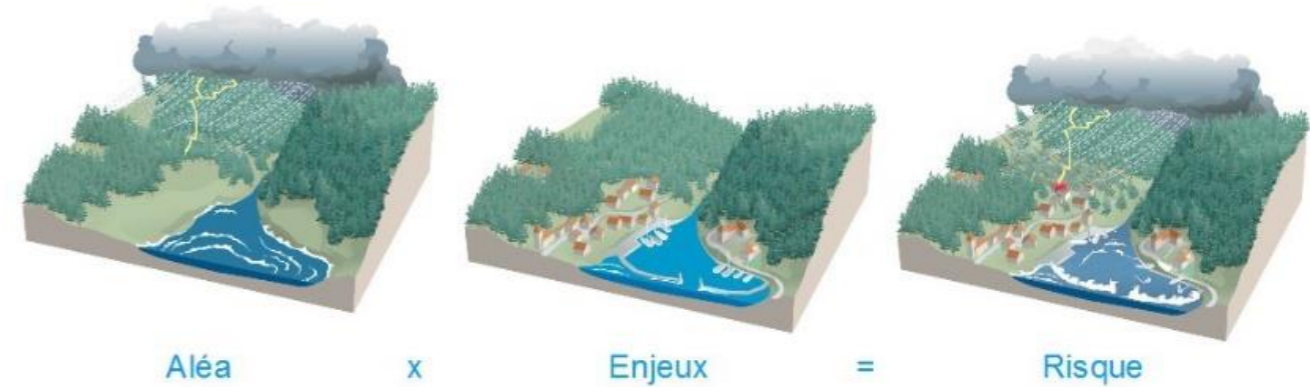
Représentation schématique du rapport existant entre les notions d'aléa, d'enjeu et de risque (source : MTES)
